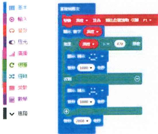
圖：Microbit監測土石流發生預警系統程式語言。
