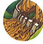
山坡野溪 設置梳子壩
